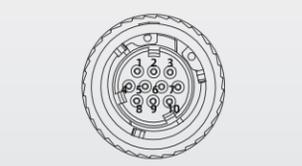
10 Pin 端子示意图 (线缆侧)
