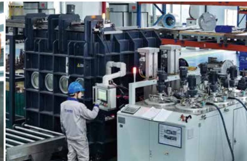
环氧树脂真空浇注自动流水线
