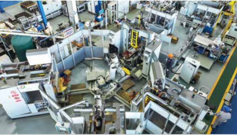
进口定子自动生产线
